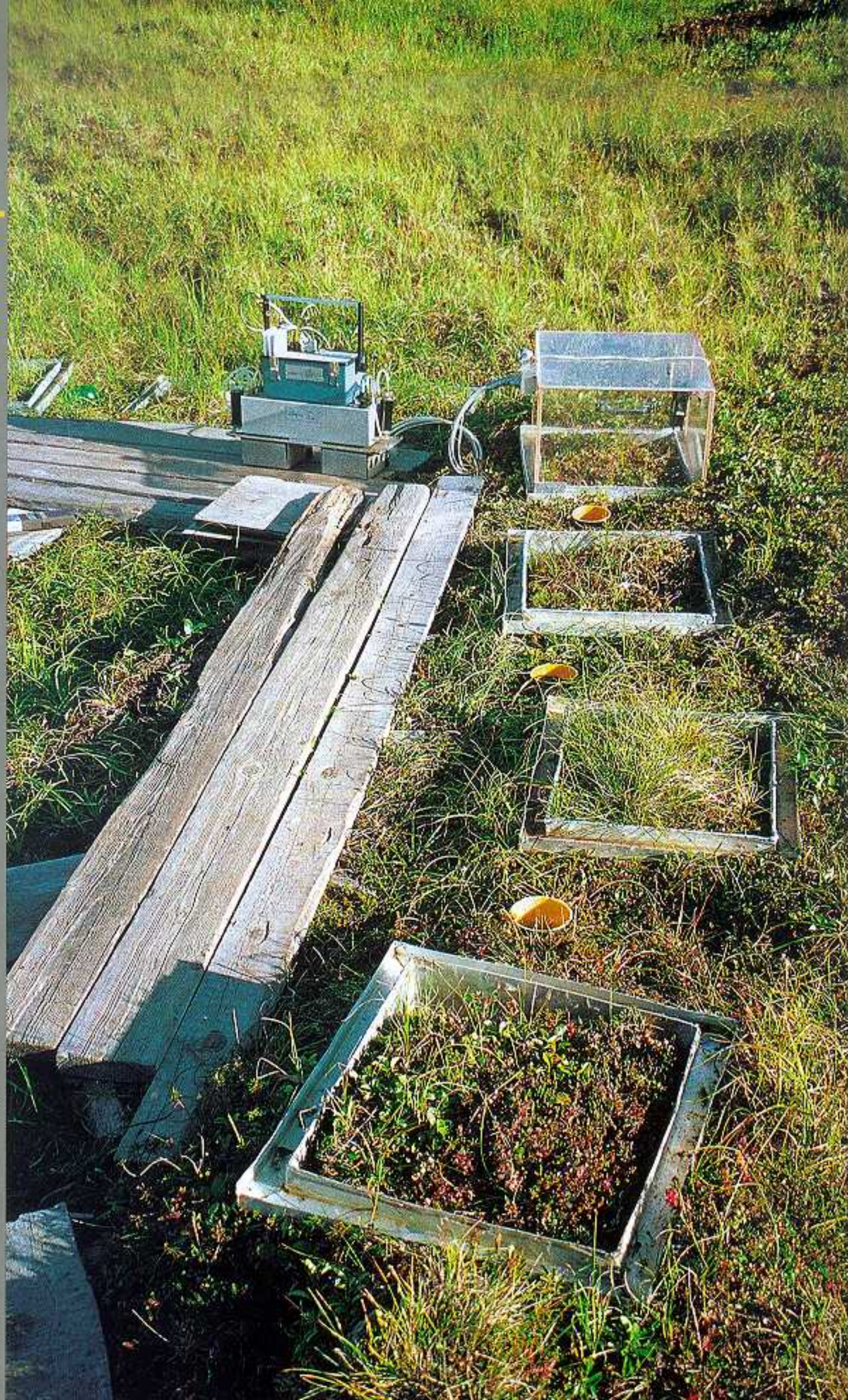
В землю вкапывают прямоугольные металлические рамы и сверху ставят прозрачную камеру. Почва «дышит», и с помощью газоанализатора выясняется состав «вдоха» и «выдоха» (слева). Ученые хранят приборы в железном ящике, чтобы их не повредили звери и не растащили люди (вверху).
