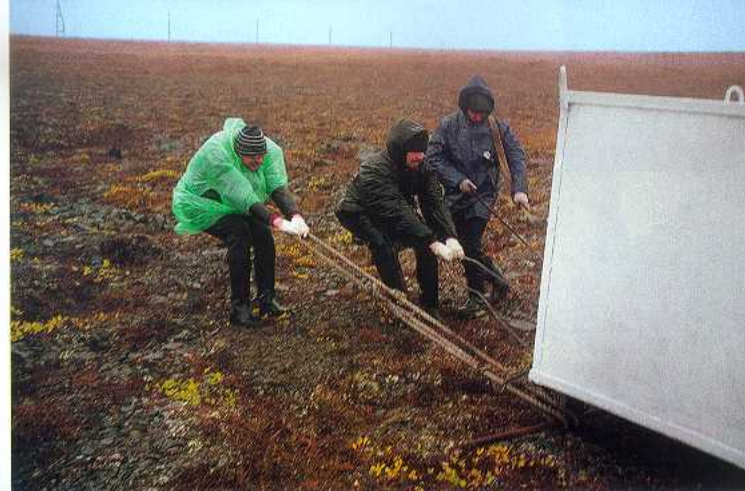
В землю вкапывают прямоугольные металлические рамы и сверху ставят прозрачную камеру. Почва «дышит», и с помощью газоанализатора выясняется состав «вдоха» и «выдоха» (слева). Ученые хранят приборы в железном ящике, чтобы их не повредили звери и не растащили люди (вверху).
